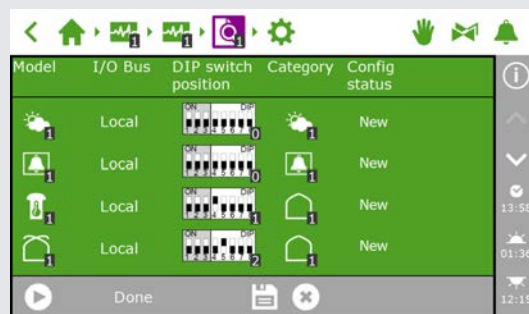
Figuur 4-2: Smart Switches gevonden in het systeem.
